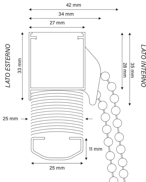
\* L'ingombro massimo del dispositivo di comando è pari a 42 mm (vedi disegno).
