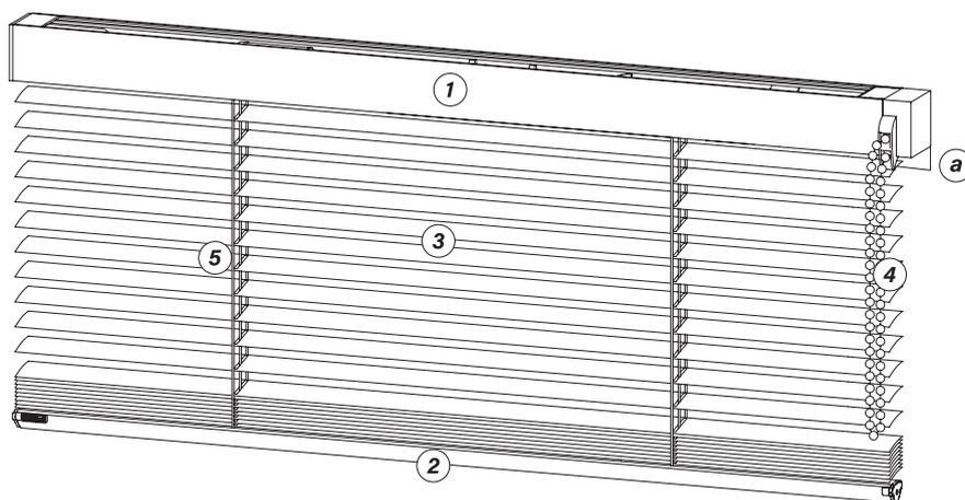
1. Profilo superiore cassonetto estruso in lega di alluminio en aw-6060 t5 mis. 27 X 28/33 X sp. 1 mm verniciato a polvere in abbinamento tinte lamelle come da campionario Silver, fornito di aletta parasole (a) in chiusura alla prima lamella sul lato esterno e munito di appositi tappi laterali di chiusura stampati a disegno.
