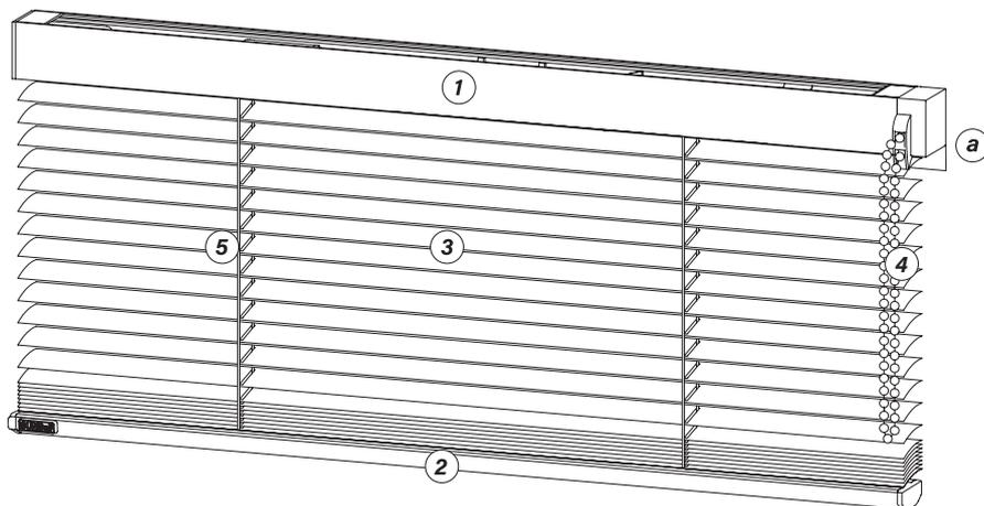
1. Profilo superiore cassonetto estruso in lega di alluminio in aw-6060 t5 mis. 27 X 28/33 X sp. 1 mm verniciato a polvere in abbinamento tinte lamelle come da campionario Silver, fornito di aletta parasole (a) in chiusura alla prima lamella sul lato esterno e munito di appositi tappi laterali di chiusura stampati a disegno.
