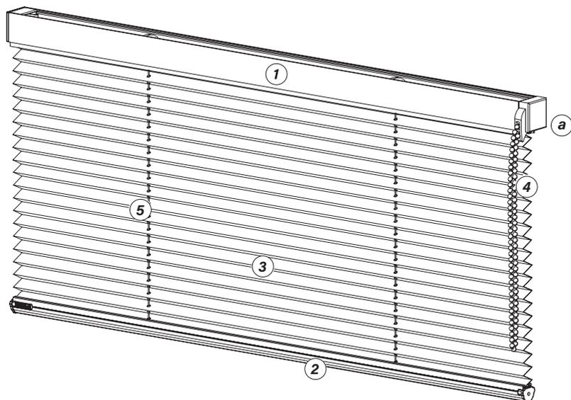
1. Profilo superiore cassonetto estruso in lega di alluminio in aw-6060 t5 mis. 27 X 32/34 X sp. 1 mm ossidato argento, verniciato bianco in abbinamento a tessuto colore 000, fornito di aletta parasole <sup>a</sup> in chiusura sul lato esterno e munito di appositi tappi laterali di chiusura stampati a disegno.
