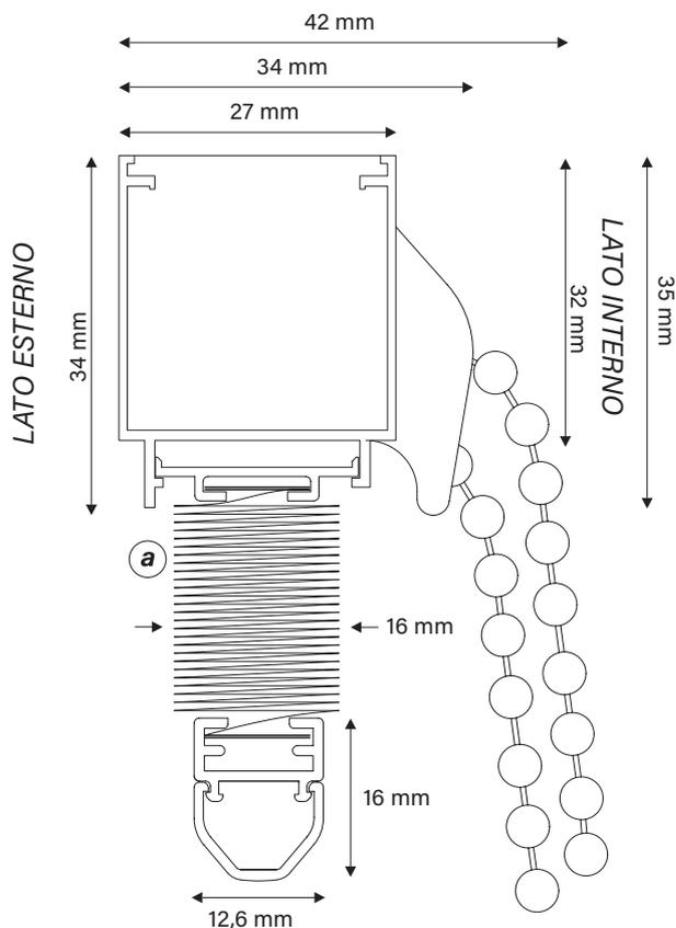
\* L'ingombro massimo del dispositivo di comando è pari a 42 mm (vedi disegno).
