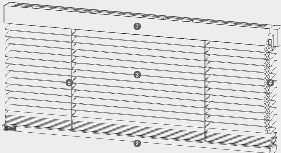
**1** Profilo superiore cassonetto estruso in lega di alluminio in aw-6060 t5 mis. 27.6 X 29 X sp. 1 mm verniciato a polvere in abbinamento tinte lamelle come da campionario Silver, fornito di aletta parasole **a** in chiusura alla prima lamella sul lato esterno e munito di appositi tappi laterali di chiusura stampati a disegno.
